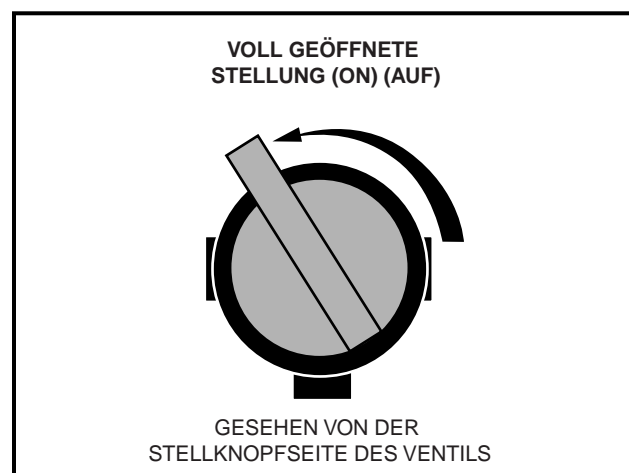
Abbildung 13 Öffnen Sie das Kraftstoff-Abschaltventil
